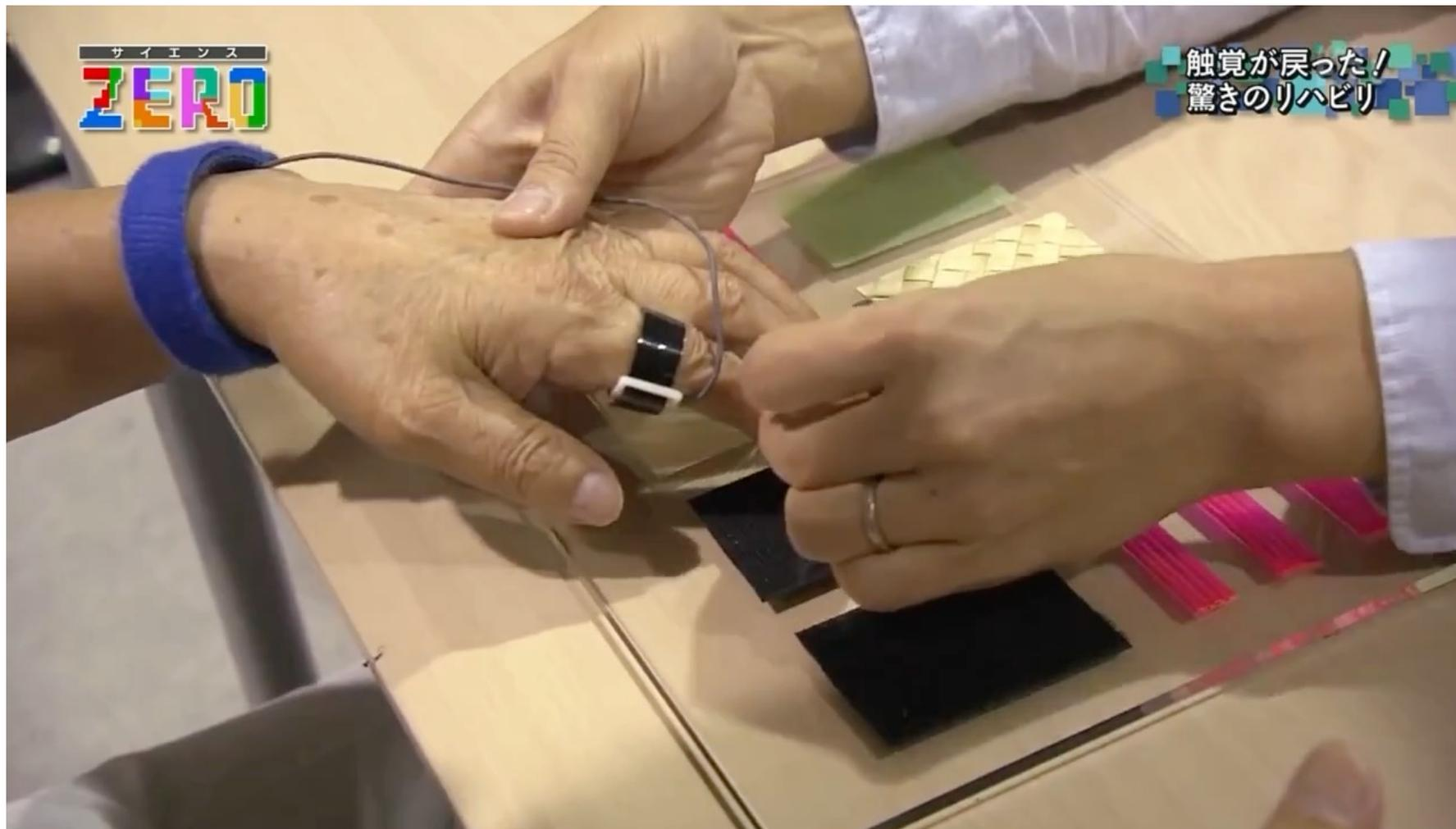
手の甲に振動子で指先の振動を指センサーでセンシングしてリアルタイムに振動をフィードバック
